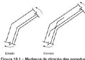
Figura 18.1 – Mudança de direção das armaduras
